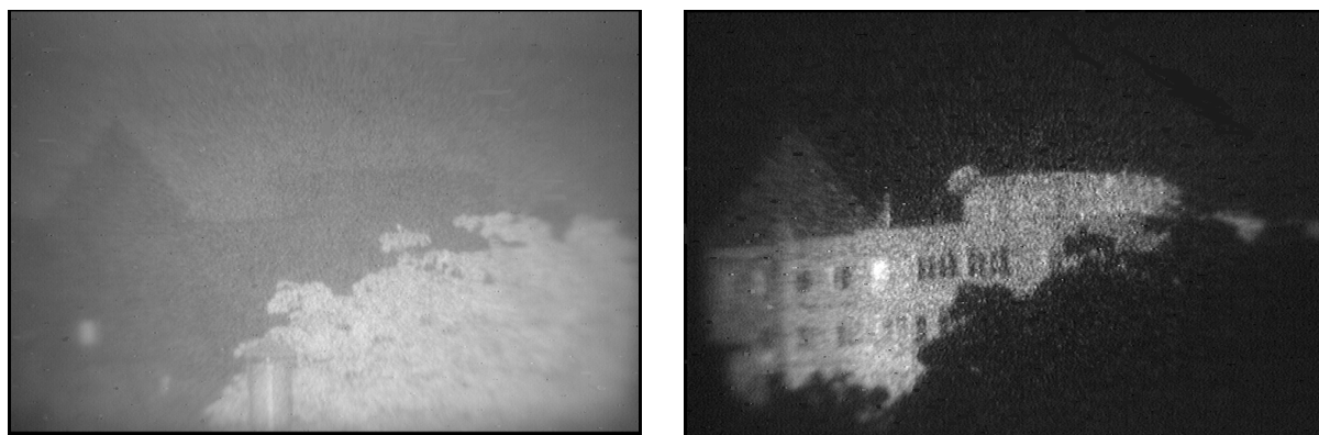
Рис. 2. Изображение на экране монитора с лазерной подсветкой в режимах без стробирования (слева) и со стробированием по дальности (справа). Дистанция – 1 км.
