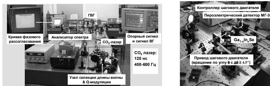
Рис.2. Внешний вид и состав установки по ГВГ \text{CO}_2 -лазера.
