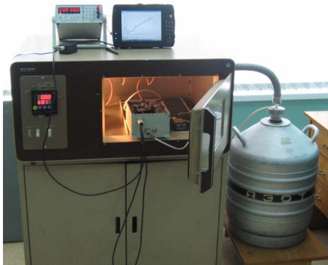
Рис. 3. Проведение испытаний блоков бортовых приборов
