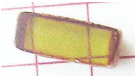
Рис. 2. Заготовка для получения волновода Cr:ZnSe на ZnSe методом травления
