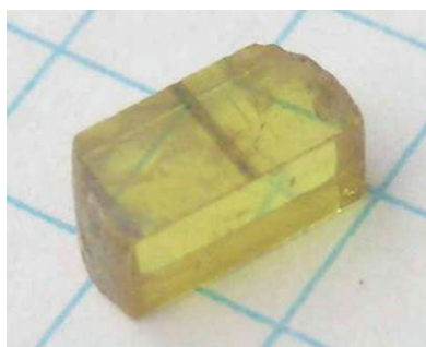
Рис. 1. Волновод Cr:ZnSe на ZnSe полученный методом селективной диффузии
