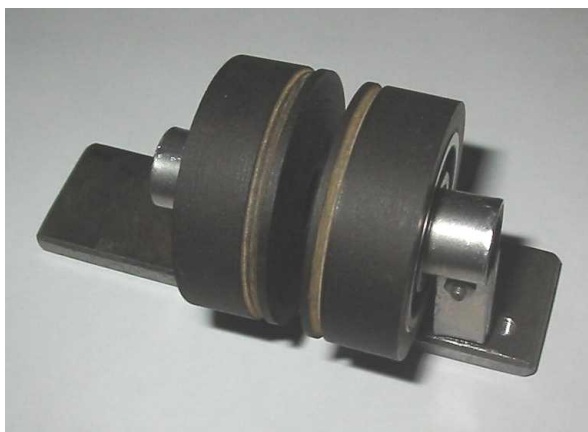
Рис. 1. Узел, обеспечивающий крепление, юстировку и независимое вращение двух расположенных последовательно вплотную друг к другу бипризм.
